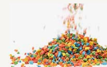
EPDM Granulate für Bodenbeläge
